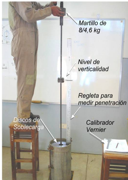
Figura 4- Ensayo DCP llevado a cabo en laboratorio.
