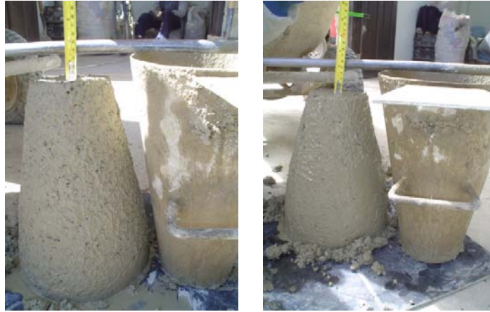
Figura 5 – Revenimiento de mezclas con agregado chancado.
