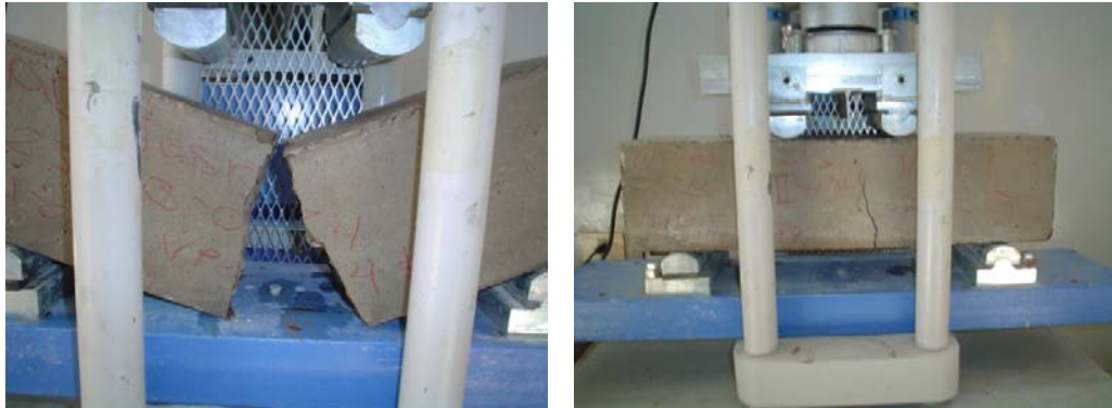
Figura 6 – Rotura de viga después del ensayo a flexión: a) sin fibra y b) con fibra
